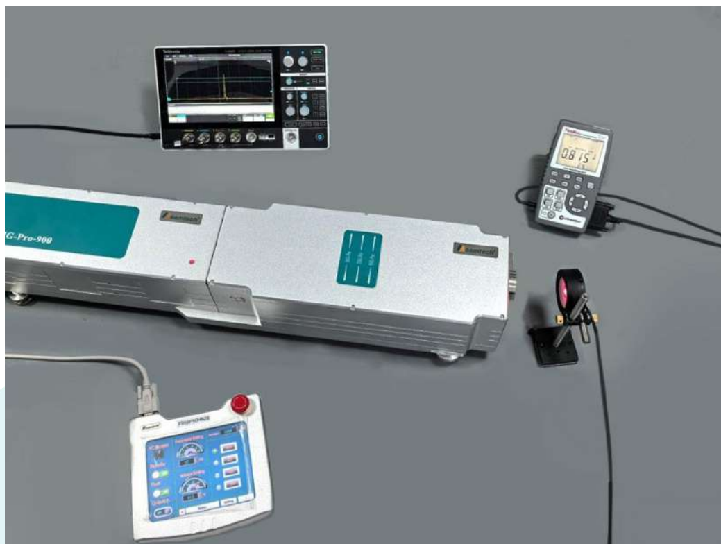
24h激光单脉冲脉冲能量测试数据（1064nm）
