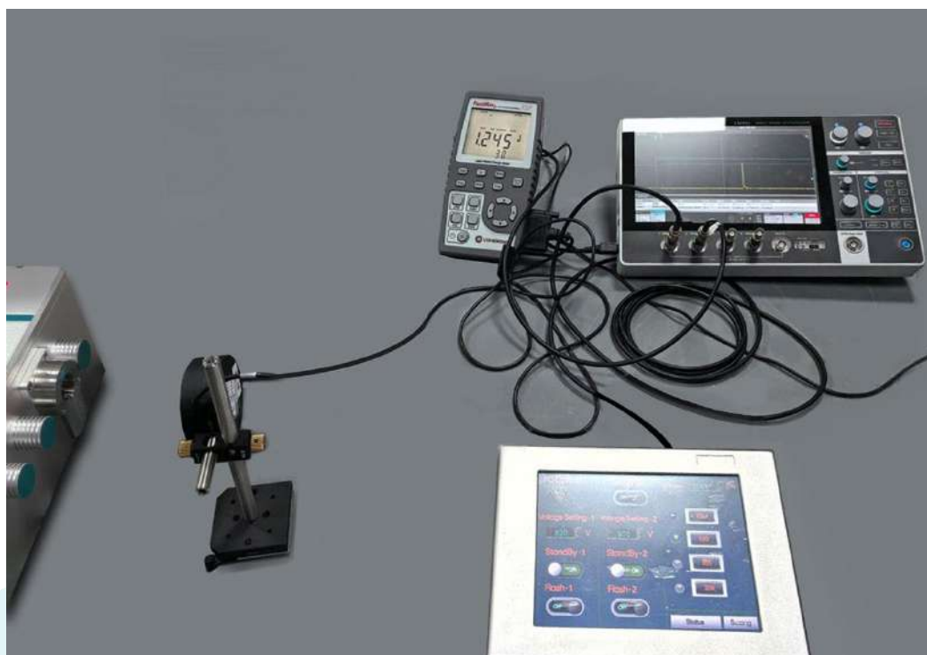
24h激光单脉冲脉冲能量测试数据（532nm）
