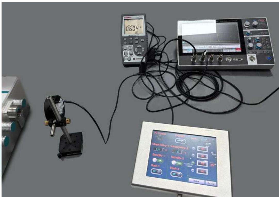
24h激光单脉冲脉冲能量测试数据（355nm）
