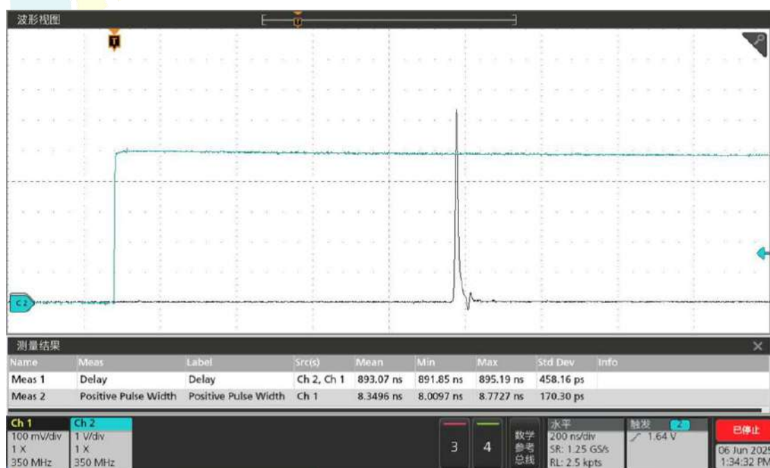
1064nm激光脉冲宽度 (24h)
