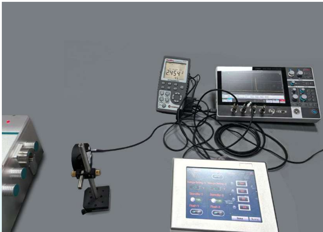
24h激光单脉冲脉冲能量测试数据（1064nm）
